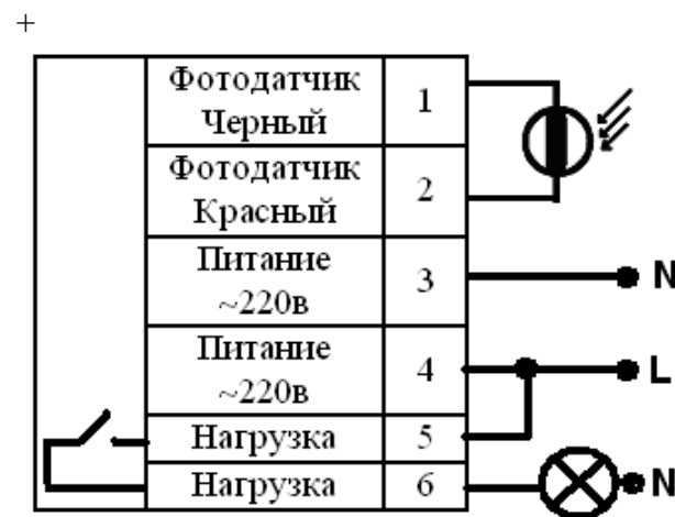
Рис. 3. Типовая схема подключения фотореле к сети 220в.
