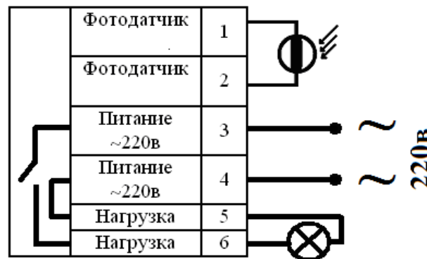
Рис. 4. Типовая схема подключения фотореле к сети 220в.
