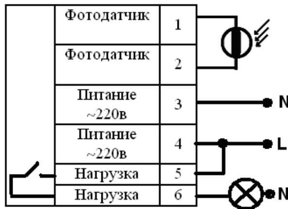
Рис.4. Типовая схема подключения фотореле к сети 220в.
